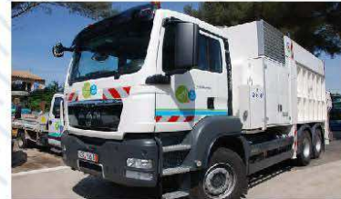
Le camion aspirateur permet de réduire les emprises de chantier, limite les nuisances pour les riverains et améliore l'ergonomie et la sécurité des agents.
